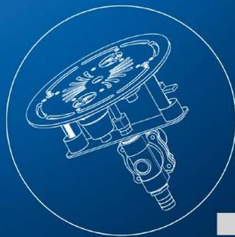
قطعات بکار رفته در نازل کف خشک شرکت آب آرا از جنس های استیل ۳۰۴ و استیل ۳۱۶ می باشند. استیل مقاوم ترین و بادوام ترین متر یال قابل استفاده در تجهیزات آبنما می باشد. ویژگی های استیل آلیاژ های ۳۰۴ و ۳۱۶ در کنار دقیق بالا در طراحی توسط مهندسین متخصص حوزه آبنما و پروسه های ساخت مکانیزه باعث شده تا محصولی با کیفیت بالا طراحی و تولید شود و در اختیار مصرف کننده قرار گیرد.
