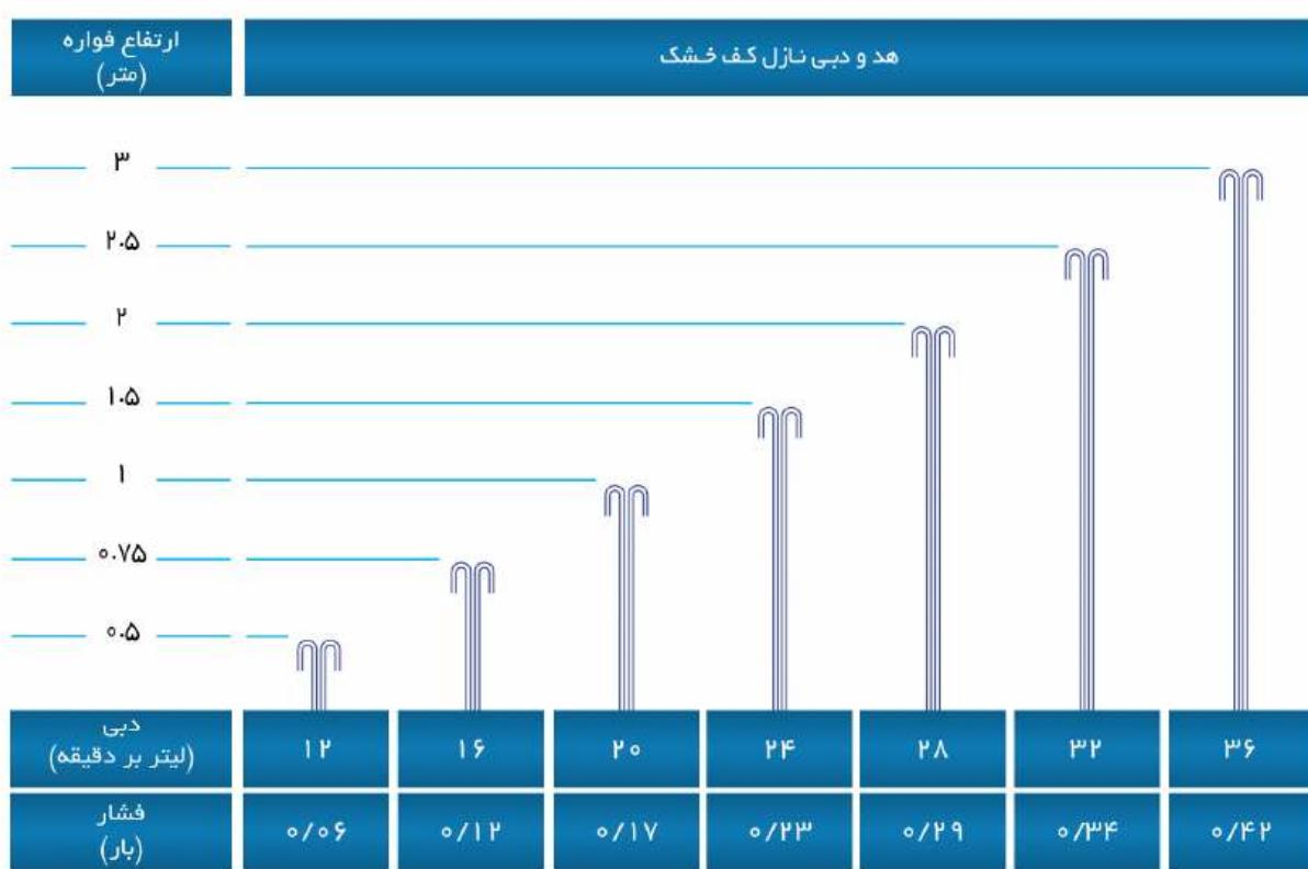
استفاده از نازل کف خشک به دلیل پکیج کردن تجهیزات مورداستفاده در این نوع آبنماها، پروسه‌ی اجرا و تعمیر نگهداری آن‌ها را به مراتب آسان می‌کند. کاربر با صرف کمترین وقت و انرژی به تجهیزات اصلی آبنما مانند چراغ و شیر برقی و شیر تنظیم دسترسی دارد. همچنین کاربر با برداشتن نازل کف خشک می‌تواند بازدیدهای دوره‌ای تأسیسات زیربنایی آبنما را به راحتی انجام دهد.
