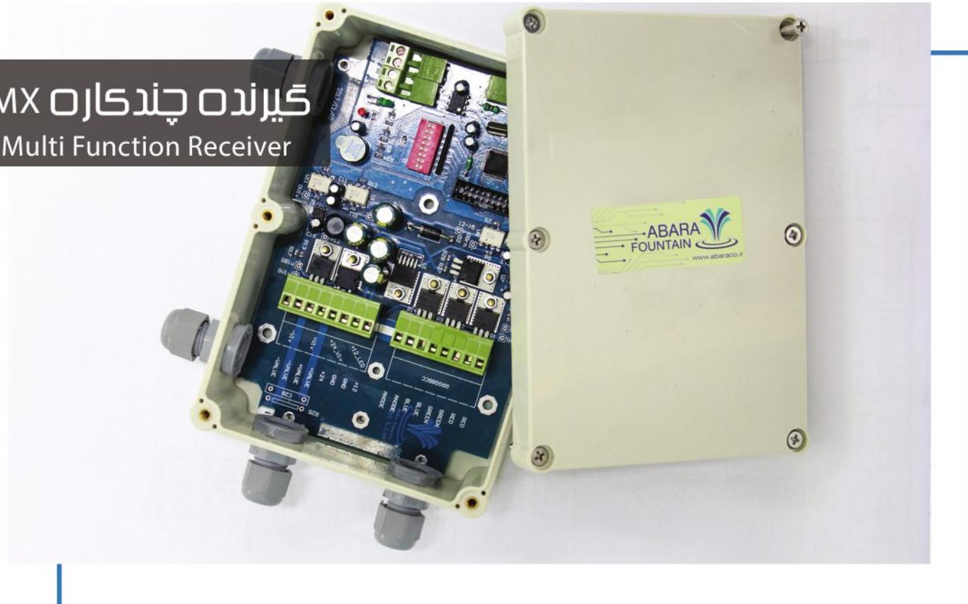
این دستگاه یک گیرنده چندکاره جامع برای آبنمای مبتنی بر DMX می باشد. با استفاده از این گیرنده می توان تجهیزات عادی آبنا را به پروتکل DMX مجهز کرد و بر روی شبکه DMX بکار گرفت. این نسخه برای آبنمای دارای شیربرقی بهینه سازی شده است و قابلیت کنترل یک نازل دارای شیربرقی DC و یک خروجی چراغ LED RGB را دارد. این گیرنده ها در جعبه های ضد آب قرار داشته و قابلیت استفاده مستغرق در آبنا را دارند. با استفاده از این کنترلر می توان تمامی تجهیزات با مشخصات عملکردی مشابه در آبنا را نیز کنترل نمود.
